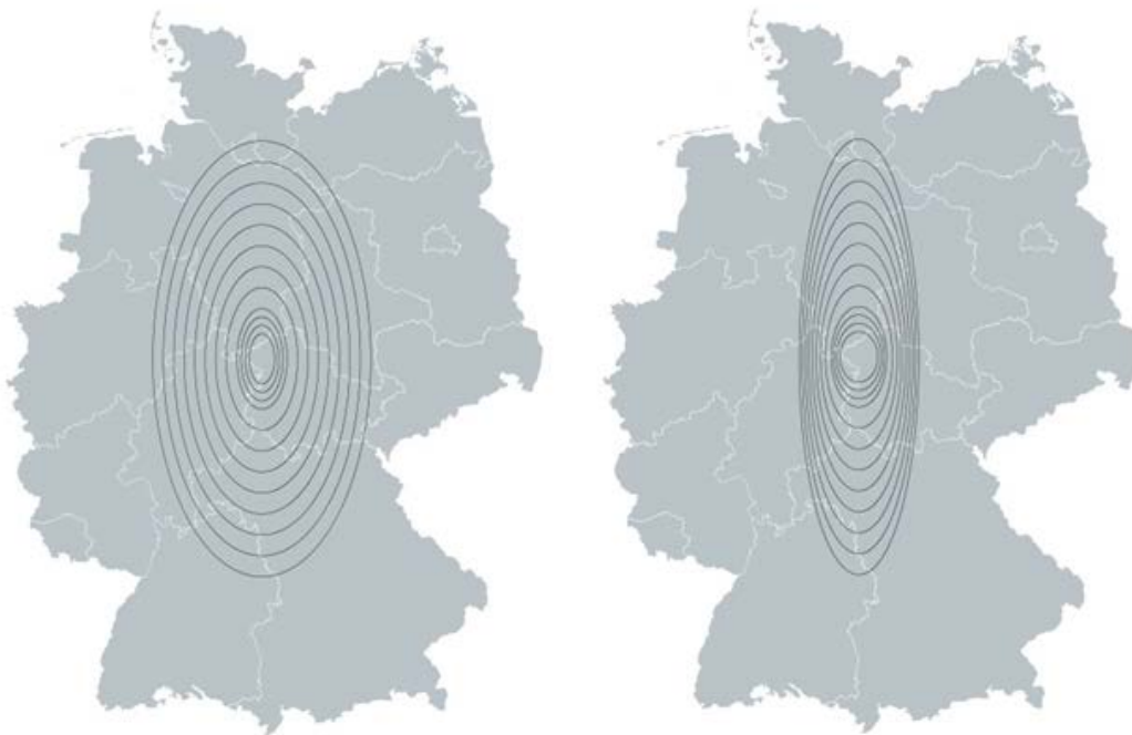
Abbildung 2: Beispielhafte Gegenüberstellung der herkömmlichen 2:1-Ellipse am Untersuchungsraum eines fiktiven Vorhabens gegenüber der aufgrund des Erdkabelvorrangs gewählten flacheren HGÜ-Ellipse für das gleiche Vorhaben.
