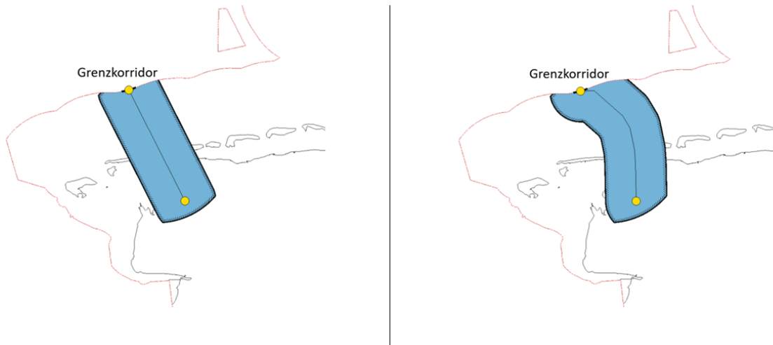
Abbildung 11: Untersuchungsraum für Offshore-Anbindungsleitungen bei unbekanntem Verlauf der Anbindungsleitung (links); Abgrenzung eines an der AWZ endenden Untersuchungsraums bei bekanntem Verlauf der Anbindungsleitung (rechts)
