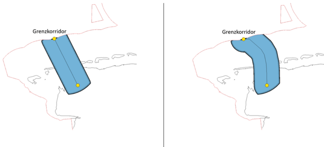
Abbildung 20: Untersuchungsraum für Offshore-Anbindungsleitungen bei unbekanntem Verlauf der Anbindungsleitung (links); Abgrenzung eines an der AWZ endenden Untersuchungsraums bei bekanntem Verlauf der Anbindungsleitung (rechts) (Quelle: Bundesnetzagentur)
