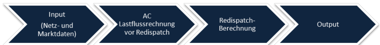
Abbildung 5. Modellablauf zum IFHT Redispatchmodell
