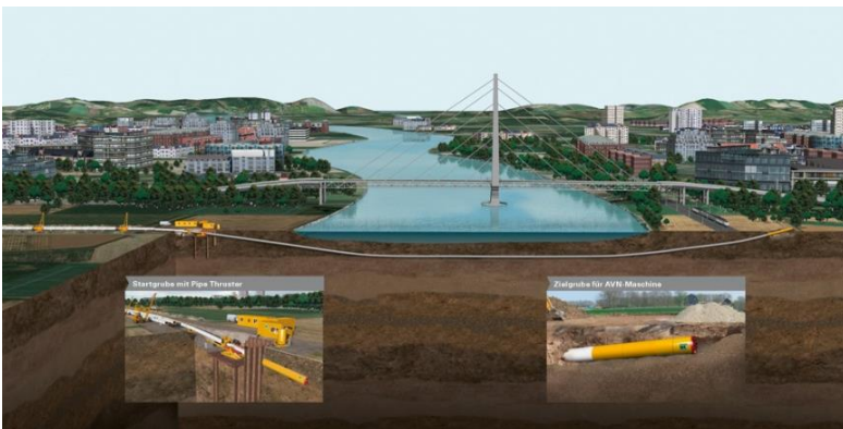
Abbildung 3-14: Direct-Pipe-Verfahren (Quelle: Herrenknecht AG)
