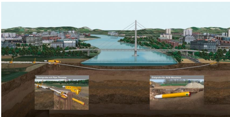
Abbildung 3-17: Direct-Pipe-Verfahren (Quelle: Herrenknecht AG)
