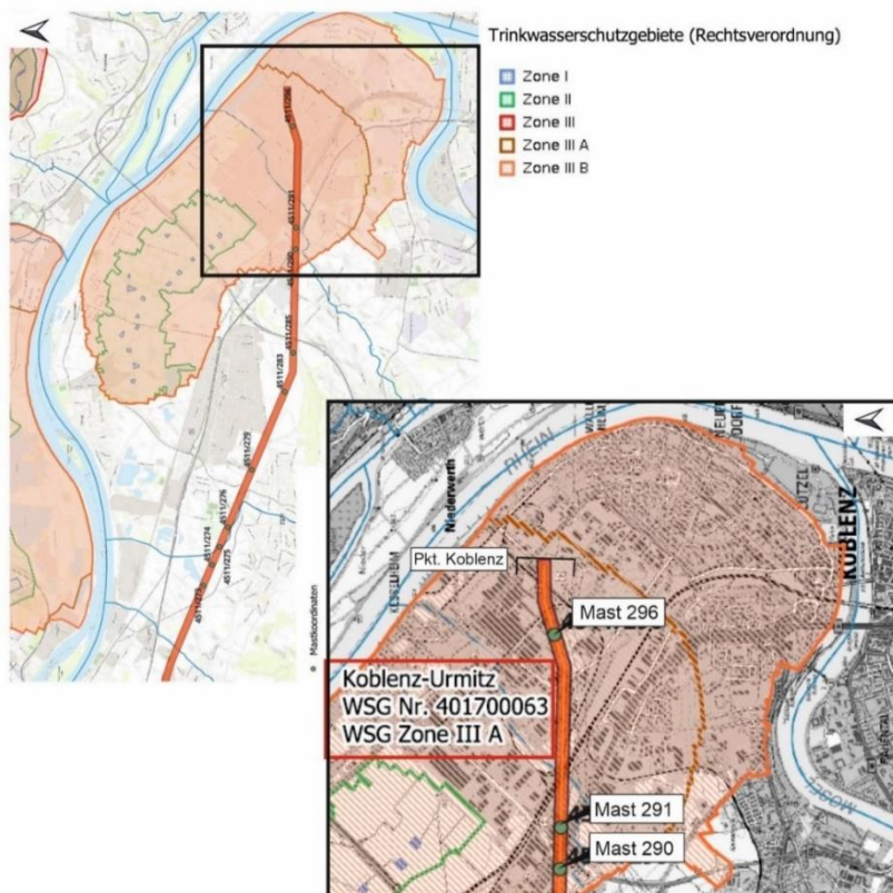
Abbildung 1: Lage der Bl. 4511 im Wasserschutzgebiet Koblenz-Urmitz Markiert sind die Maststandorte mit geplanten Fundamentverstärkungsmaßnahmen (Quelle: https://wasserportal.rlp-umwelt.de/ )
