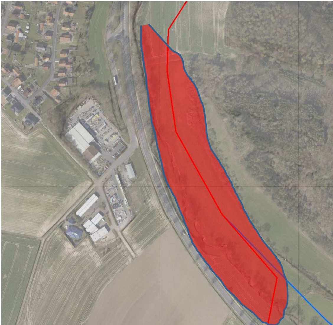
Abbildung 6: Mögliche Instabilitäten im Bereich des Trassenverlaufes östlich von Delligsen. Dies würde beide Alternativen HDD 1 und 2 betreffen.
