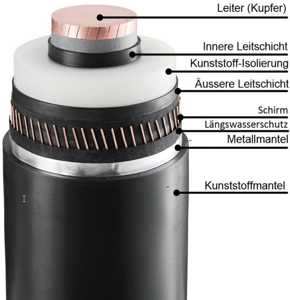
Abbildung 5: Kabelaufbau DC kunststoffisoliertes Erdkabel, beispielhaft mit Kupfer-Leiter
