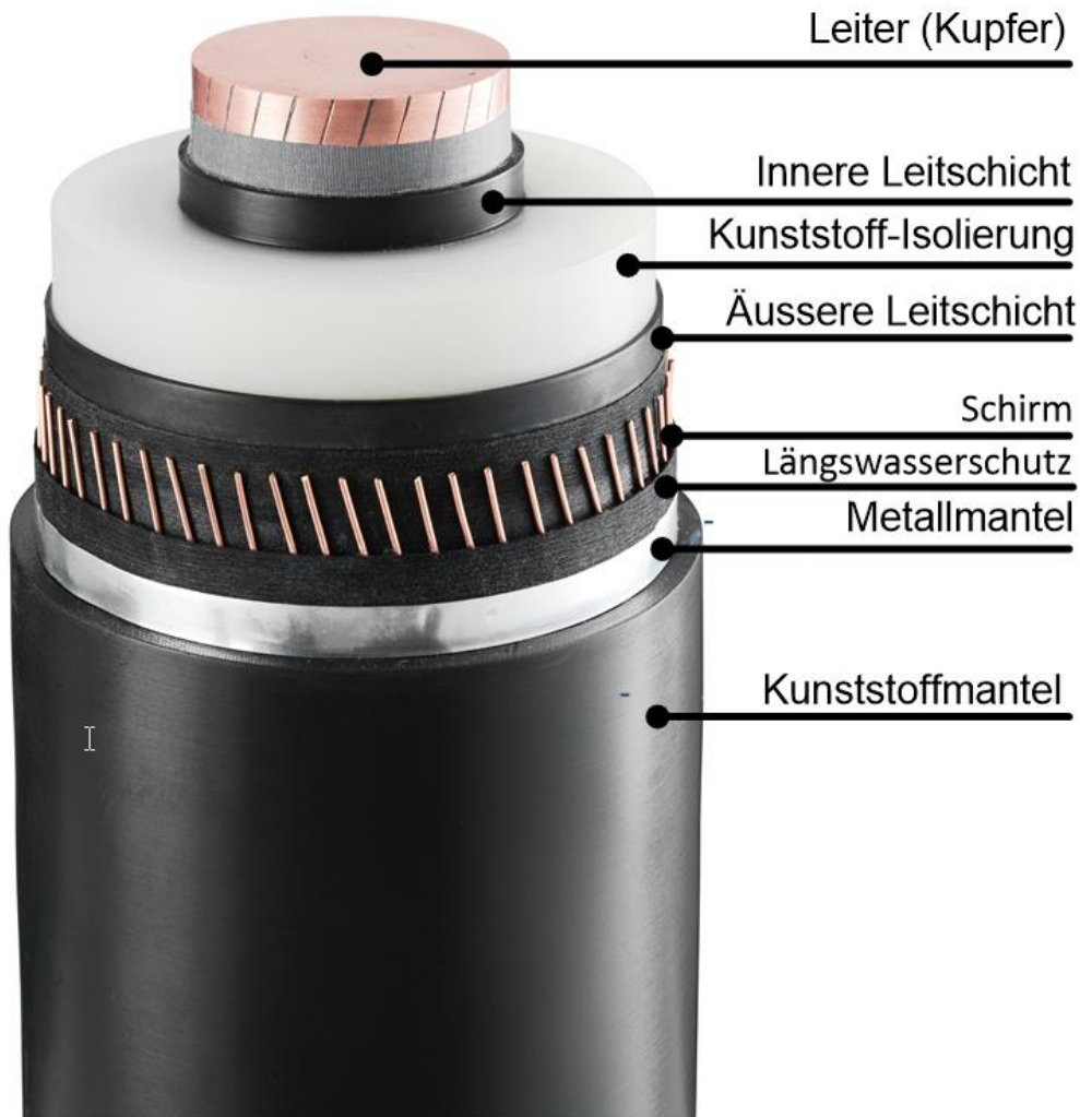
Abbildung 5: Kabelaufbau DC kunststoffisoliertes Erdkabel, beispielhaft mit Kupfer-Leiter
