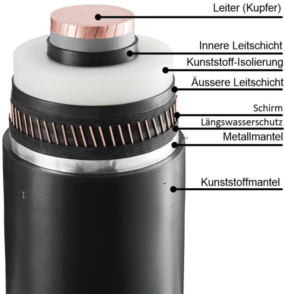
Abbildung 5: Kabelaufbau DC kunststoffisoliertes Erdkabel, beispielhaft mit Kupfer-Leiter
