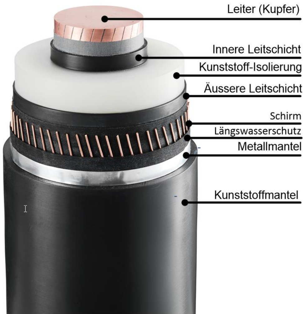
Abbildung 5: Kabelaufbau DC kunststoffisoliertes Erdkabel, beispielhaft mit Kupfer-Leiter
