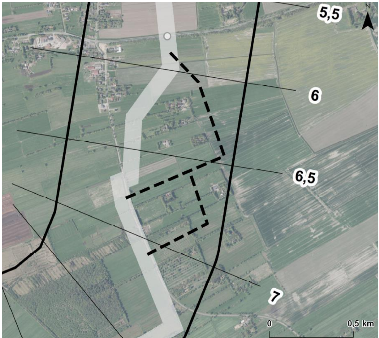
Abbildung 5: Trassenvorschlag (hellgrauer Streifen) und geprüfte nicht in Frage kommende Alternativen (gestrichelte Linien) innerhalb des Wolfsbrucher Moors, Segment 005, km 5,8 – km 7,1
