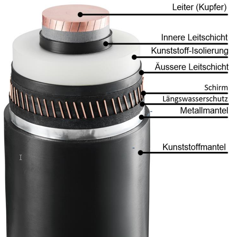
Abbildung 7: Kabelaufbau DC kunststoffisoliertes Erdkabel, beispielhaft mit Kupfer-Leiter
