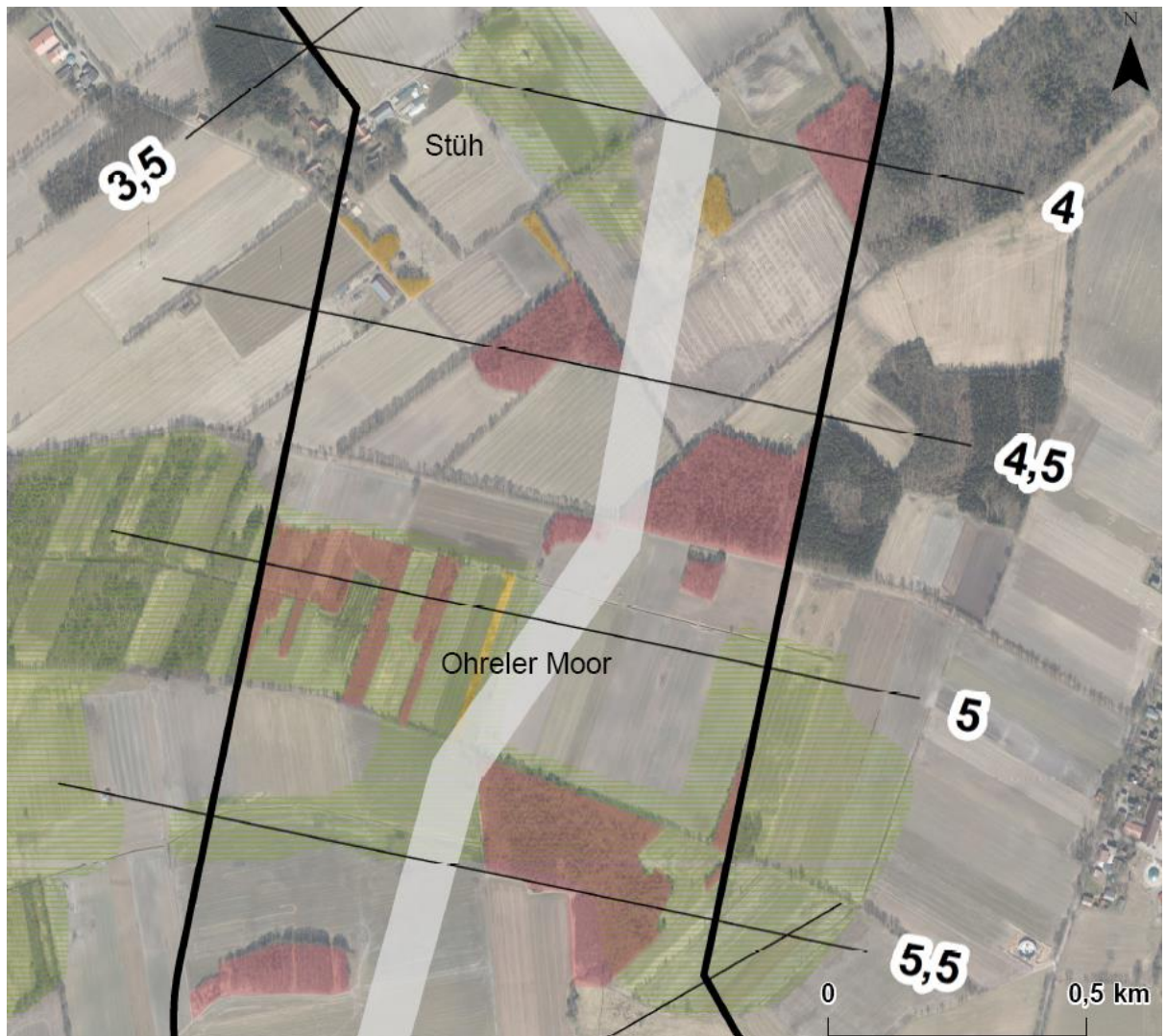
Abbildung 5: Trassenvorschlag (hellgrauer Streifen) in Segment 008, km 3,8 – km 5,8
