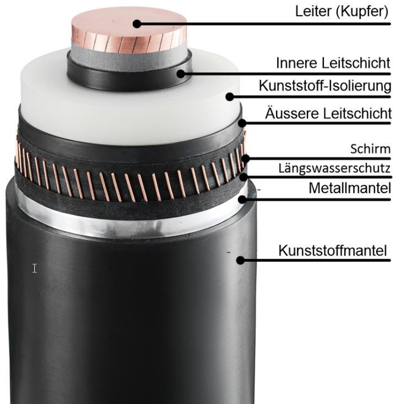
Abbildung 8: Kabelaufbau DC kunststoffisoliertes Erdkabel, beispielhaft mit Kupfer-Leiter
