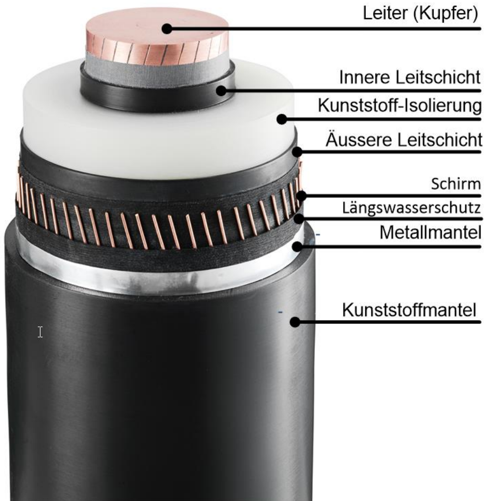
Abbildung 5: Kabelaufbau DC kunststoffisoliertes Erdkabel, beispielhaft mit Kupfer-Leiter
