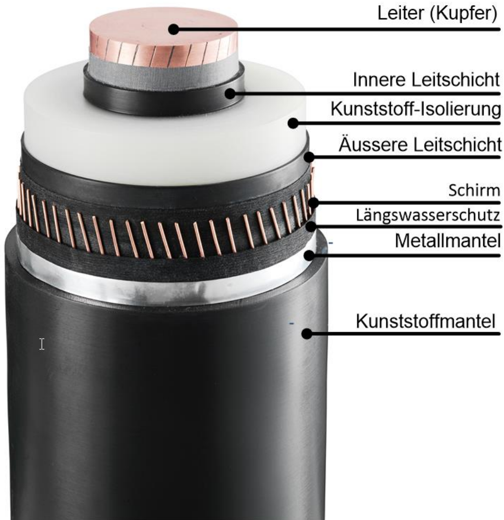
Abbildung 5: Kabelaufbau DC kunststoffisoliertes Erdkabel, beispielhaft mit Kupfer-Leiter
