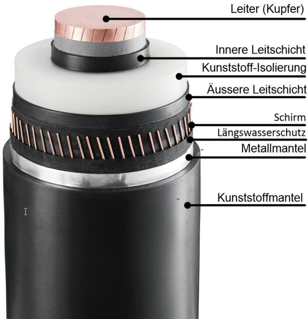
Abbildung 5: Kabelaufbau DC kunststoffisoliertes Erdkabel, beispielhaft mit Kupfer-Leiter
