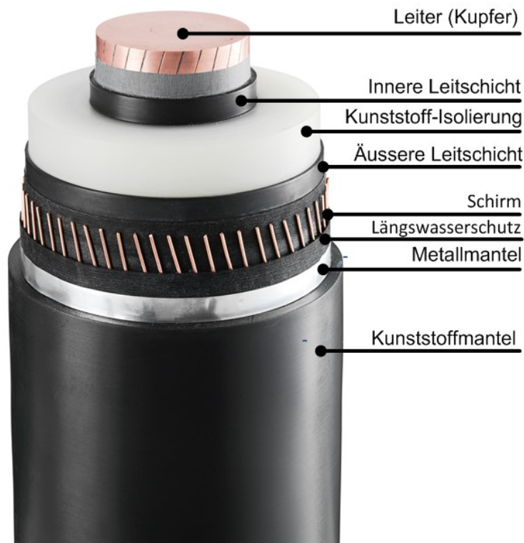
Abbildung 2: Aufbau kunststoffisoliertes Gleichstrom-Erdkabel (vergleichbar für Kabel der Spannungsebenen 320kV und 525kV) (Quelle „Broschüre Hochspannungskabel von ABB“)
