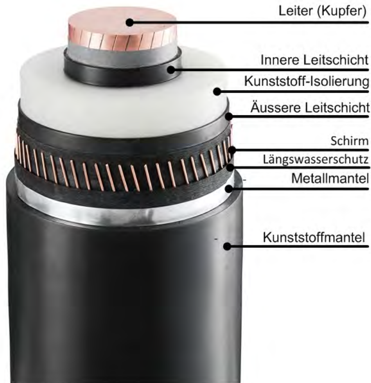
Abbildung 8: Aufbau kunststoffisoliertes Gleichstrom-Erdkabel
