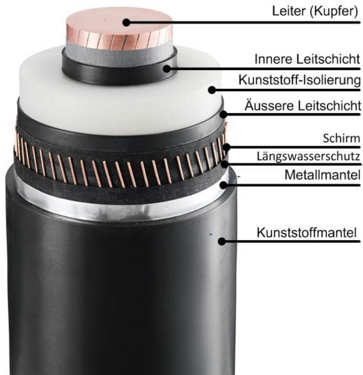
Abbildung 2: Aufbau kunststoffisoliertes Gleichstrom-Erdkabel (vergleichbar für Kabel der Spannungsebenen 320kV und 525kV)
