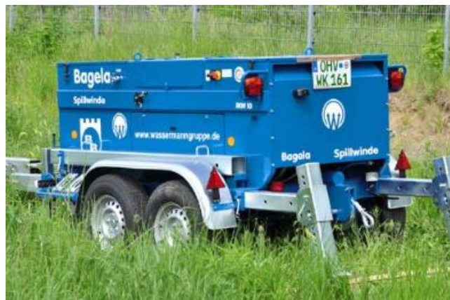
Abb. 24: Kabelziehwinde (beispielhaft Fa. Bagela)
