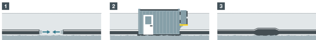
Abb. 5: Schematische Darstellung der Kabelverbindungen (Muffen)
