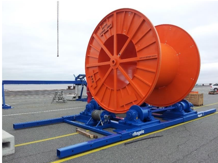
Abb. 23: Trommelbock (beispielhaft Fa. Bagela)
