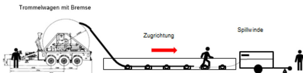
Abb. 18: Verlegung im Kabelgraben (schematischer Aufbau/Graben mit Rollenausbau)
