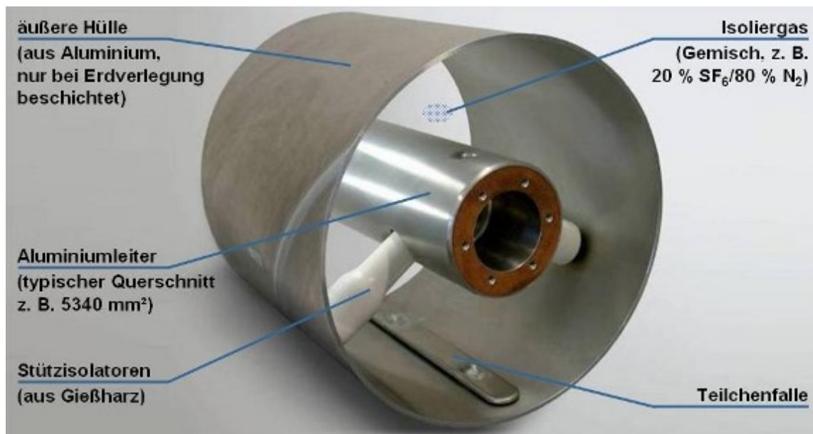
Abbildung 9: Aufbau einer gasisolierten Übertragungsleitung (GIL) (Quelle: http://www.energy.siemens.com/hq/de/stromuebertragung/gasisolierte-uebertragungsleitungen.htm )
