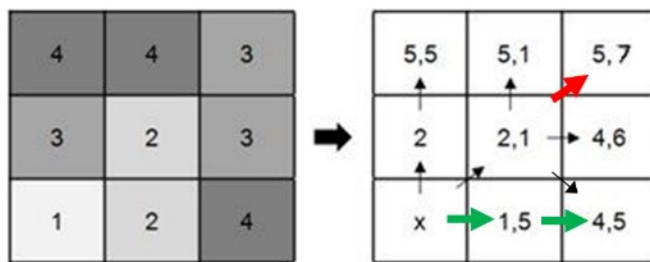
Abbildung 48: Beispiel für eine Widerstands-Entfernungs-Berechnung (links: Raster mit kombinierten Widerständen, rechts: Widerstands-Entfernungs-Raster)
