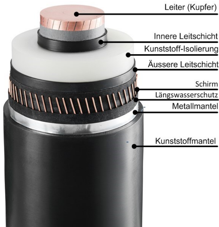
Abbildung 8: Aufbau kunststoffisoliertes Gleichstrom-Erdkabel
