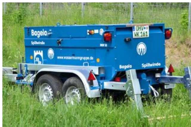
Abb. 24: Kabelziehwinde (beispielhaft Fa. Bagela)
