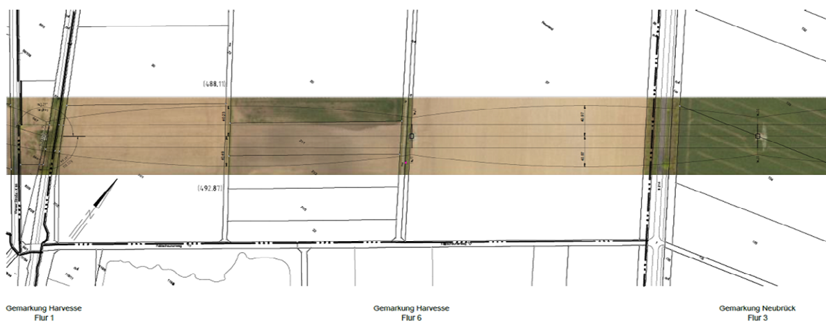
Abbildung 18: Beispiel Schutzstreifenabgrenzung (Quelle: TenneT TSO GmbH)
