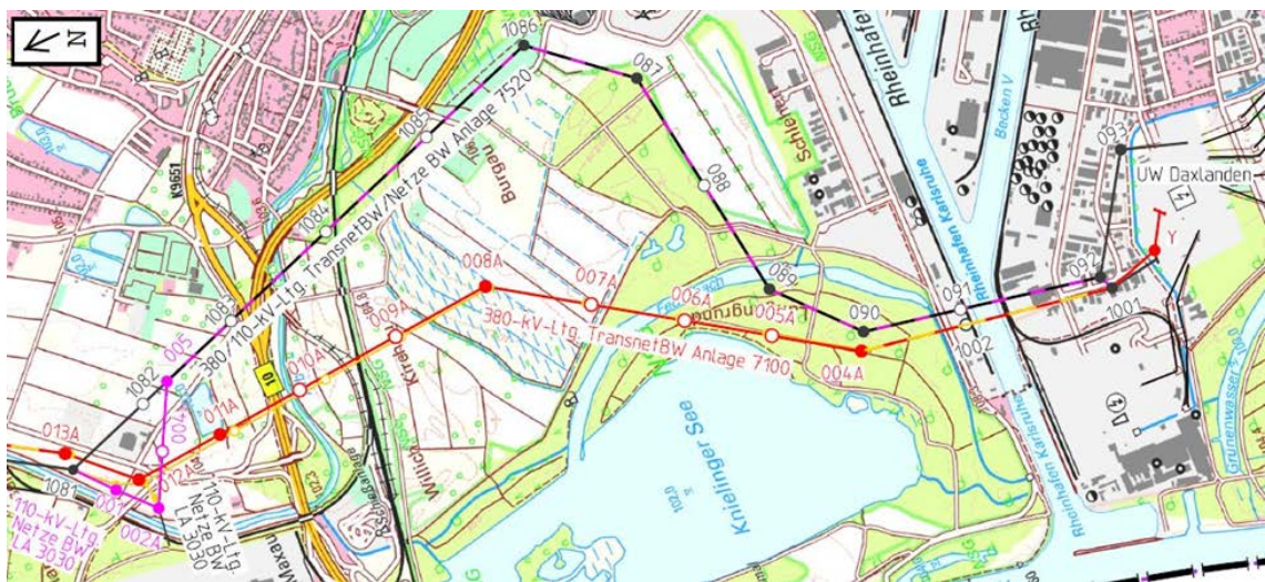
Abbildung 13: Maxau über Knielinger See bis Einföhrung ins UW Daxlanden (Ersatzneubau rot-gelb, Neubau rot, Rückbau gelb, Folgemaßnahme pink, Zubeseilung Folgemaßnahme schwarz-pink, Bestand schwarz dargestellt. Quelle: LTB Januar 2023)
