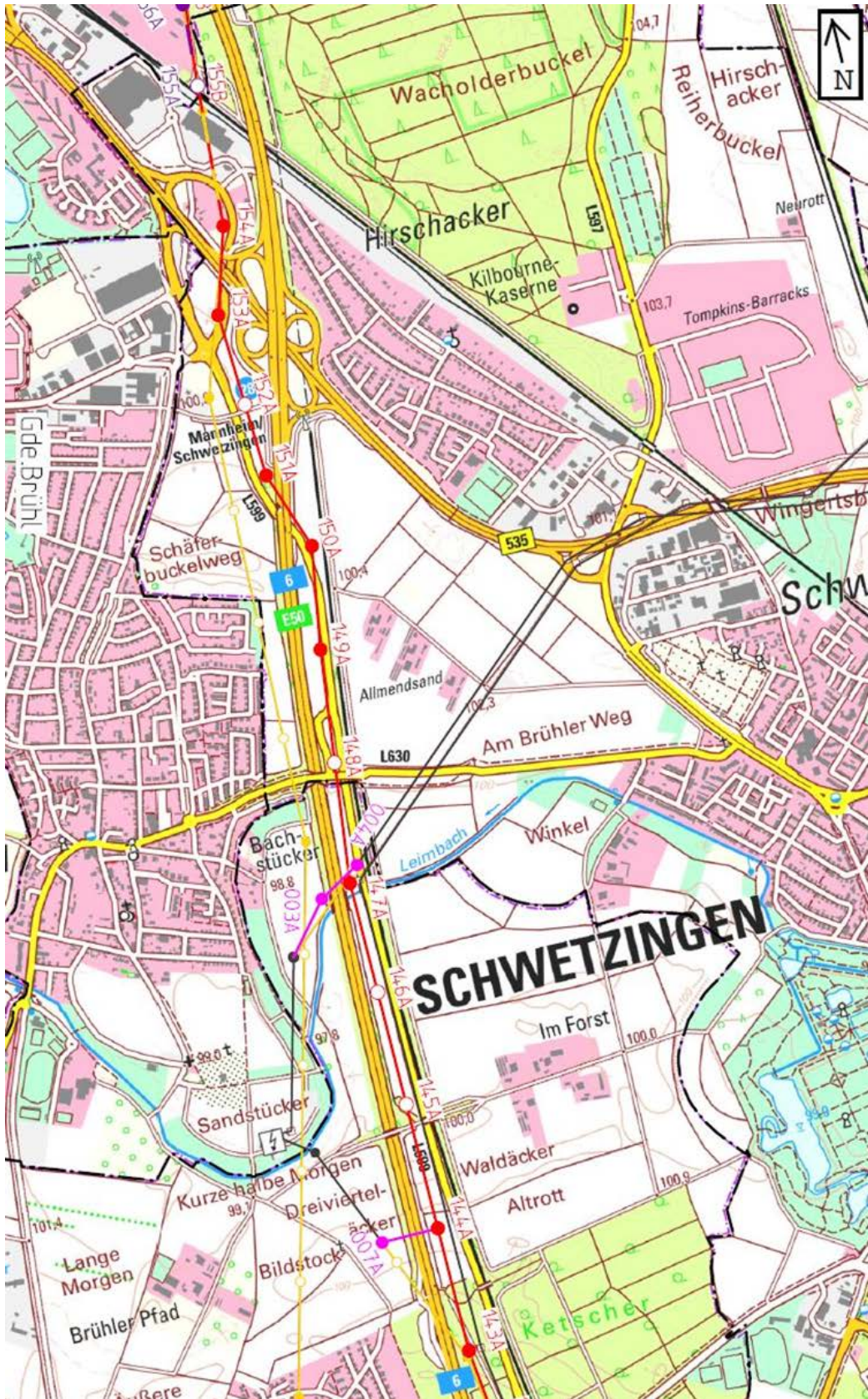
Abbildung 5: Brühl - Schwetzingen Ersatzneubau in neuer Trasse. Trassenachse: Ersatzneubau in neuer Trasse Anlage 7100 (rot dargestellt) Mast 154A bis 143A. (Bestand ist schwarz, Rückbau gelb, Folgemaßnahmen pink dargestellt. Quelle: LTB Januar 2023)
