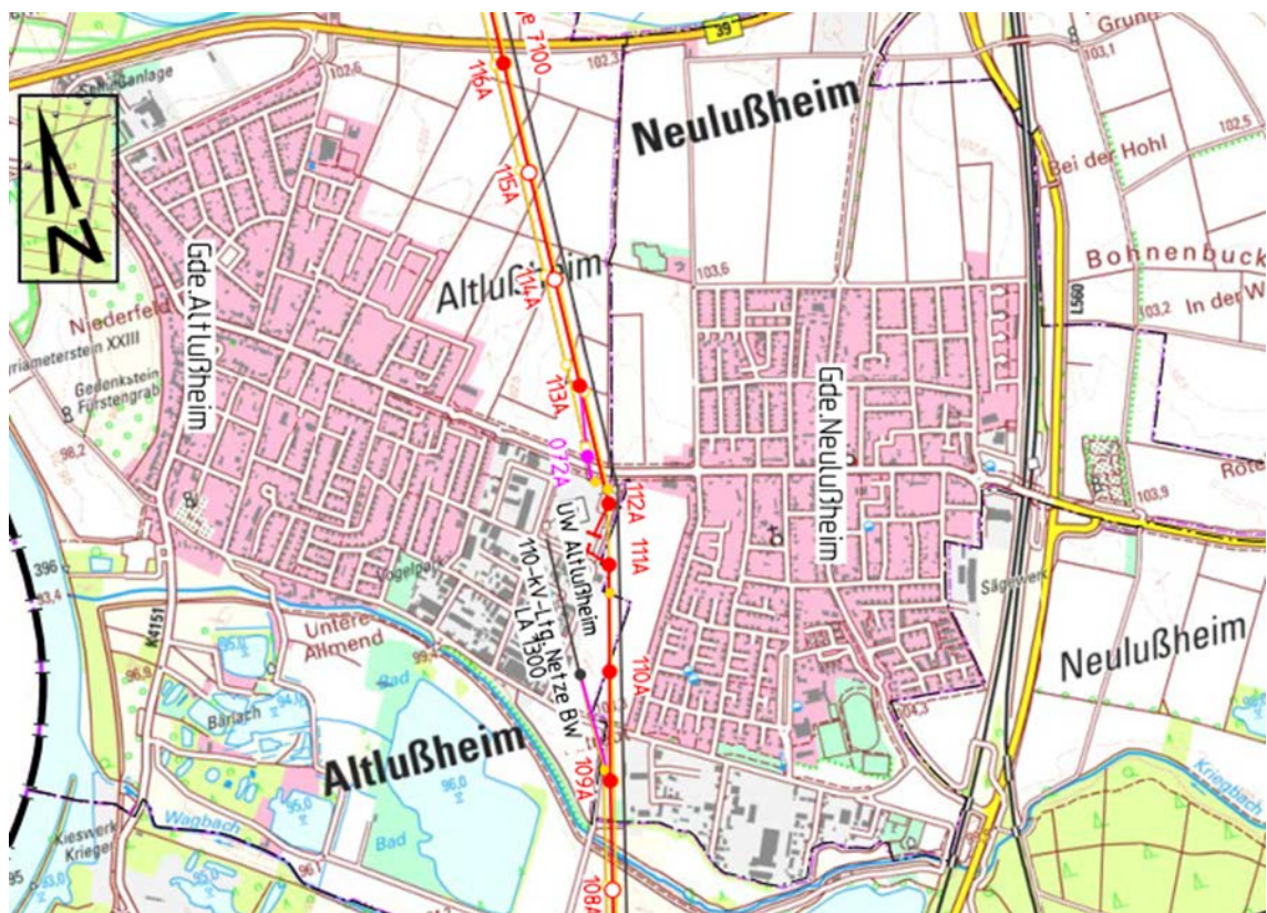
Abbildung 11: Einführung ins UW Altlußheim. Trassenachse: Ersatzneubau 7100 Mast 116A - nördliches Portal UW Altlußheim sowie südliches Portal - Mast 108A rot dargestellt. (Bestand ist schwarz dargestellt, Rückbau gelb, Folgemaßnahmen 110-kV in pink. Quelle: LTB Juni 2022)
